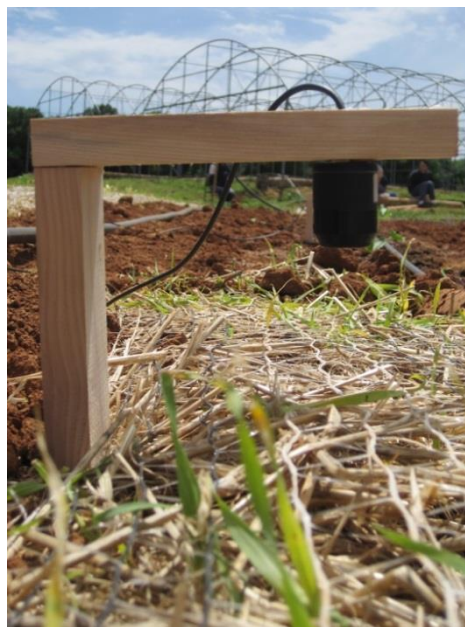
Slika 42. Senzor za FAR senzor okrenut prema malču od slame, 31. svibnja 2010.
