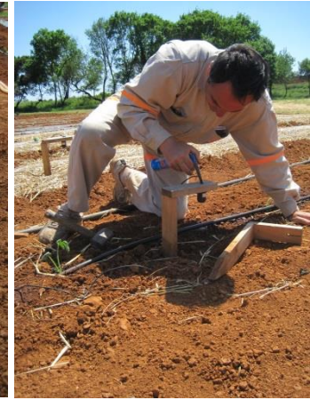
Slika 45. Postavljanje drvene konstrukcije za FAR senzor, 5. svibnja 2011.
