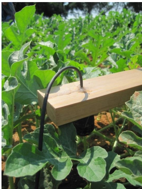
Slika 41. Senzor za FAR unutar usjeva, okrenut prema tlu, 12. srpnja 2010.
