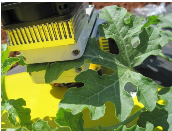
Slika 20. Komora instrumenta pričvršćena za gornju trećinu lista, 14. lipnja 2010.
