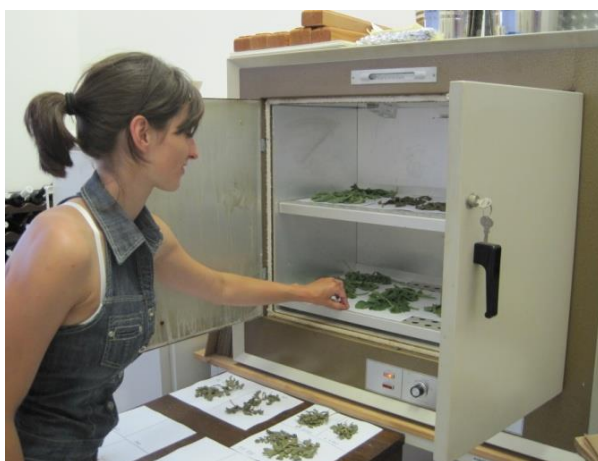
Slika 15. Sušenje lista lubenice do konstantne težine na 70°C, Institut za poljoprivredu i turizam Poreč; 1. 7. 2010.
