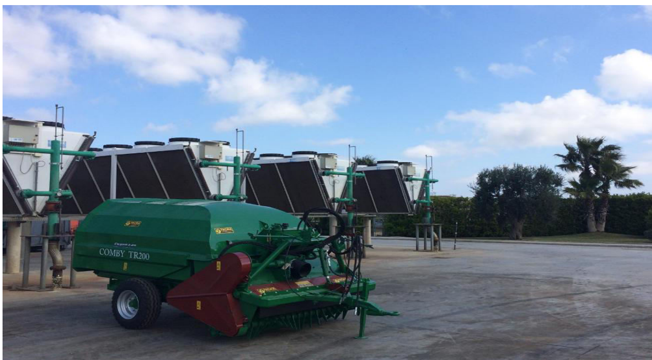
Slika 7. Stroj za prikupljanje orezane biomase (Izvor: http://fiusis.com/ )
