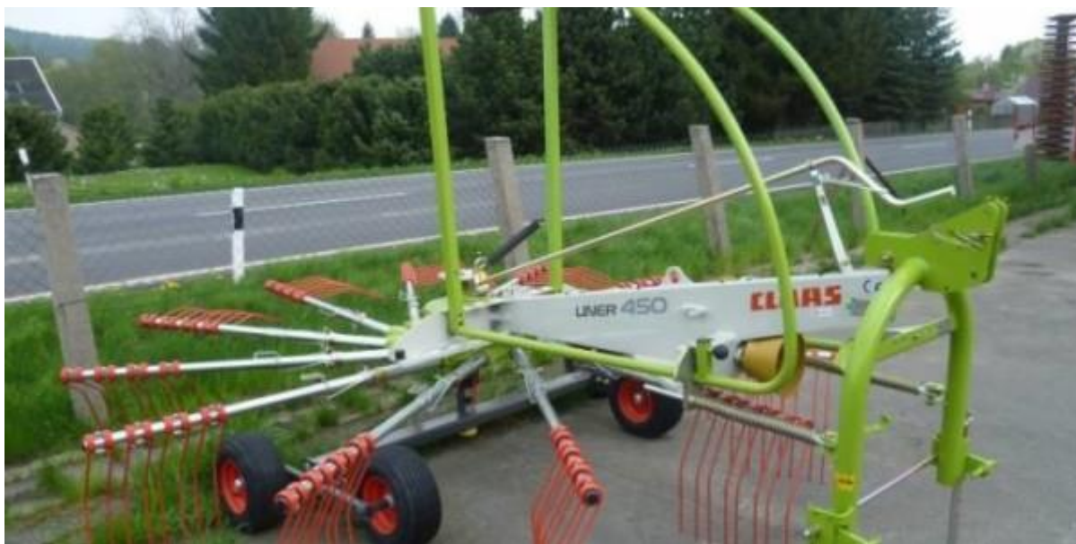
Slika 8. Rotacijske grablje sa tandem podvozjem marke Class
