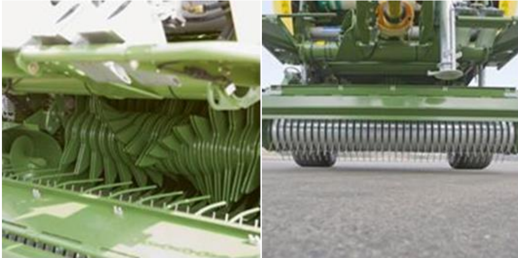
Slika 11. Uređaj za rezanje (lijevo) i uređaj za sakupljanje - pick up (desno) (izvor: www.miler.hr )
