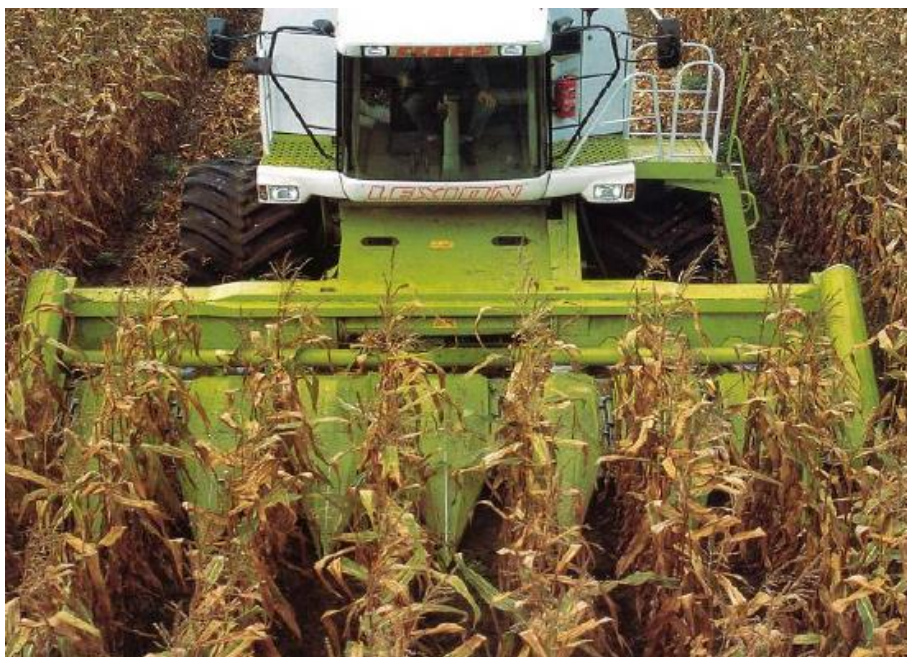
Slika 15. Višeredni adapter u berbi kukuruza
