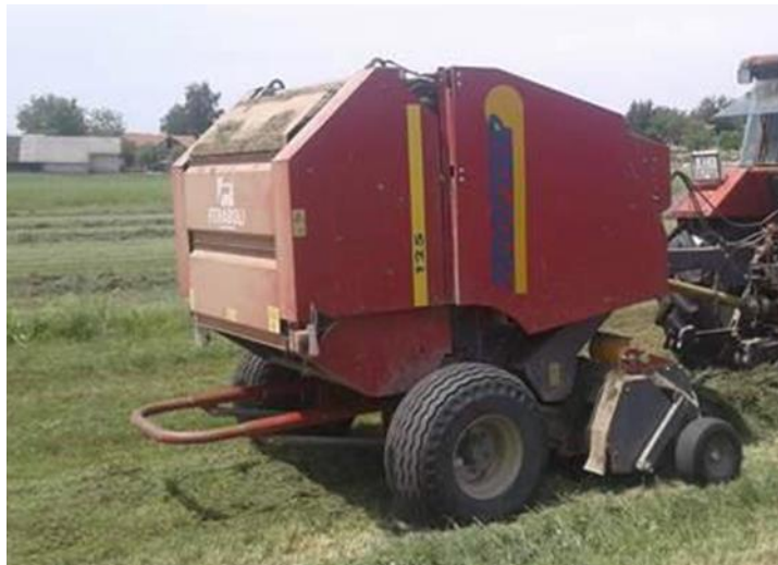
Slika 10. Preša za bale Feraboli Trotter
