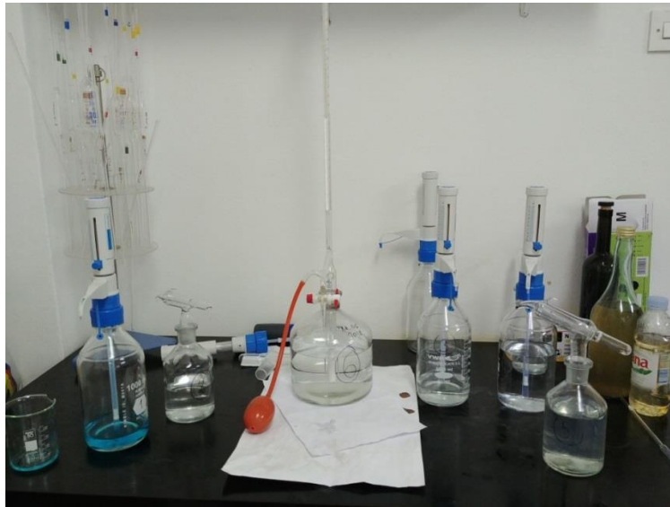
Slika 2. Aparatura za određivanje reducirajućeg šećera
