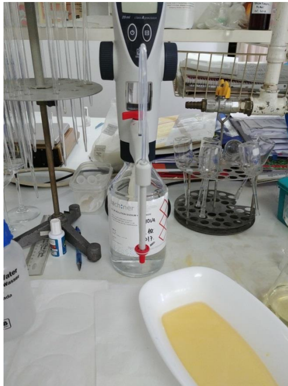
Slika 3. Aparatura za određivanje ukupne kiselosti
