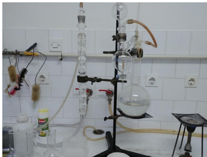
Slika 4. Aparatura za određivanje hlapive kiselosti
