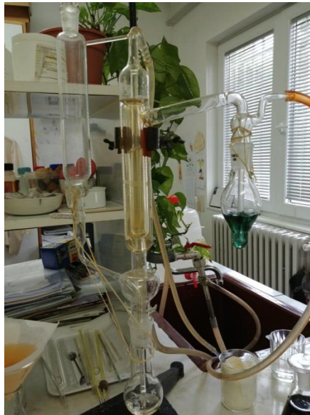
Slika 6. Aparatura za određivanje sumpora u vinu
