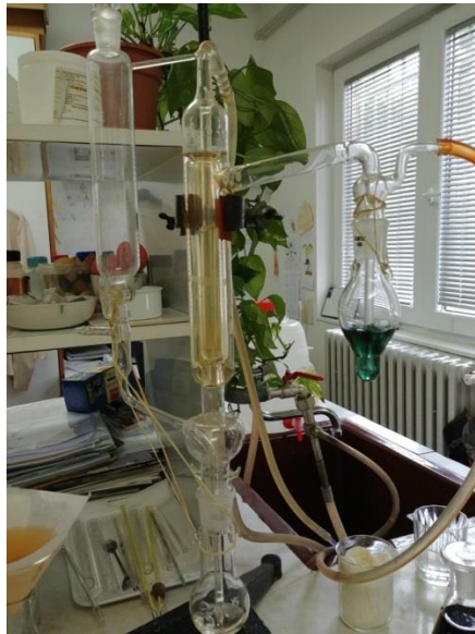
Slika 6. Aparatura za određivanje sumpora u vinu
