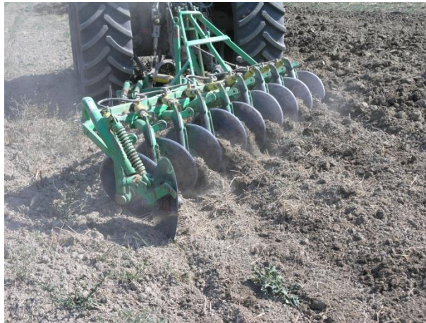
Slika 26. Oranje diskosnim plugom u ljetnom periodu (Raša)
