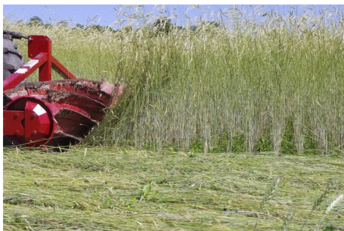
Slika 27. Valjak s nazubljenim plaštom za uništavanje pokrovnih usjeva (izvor: scslabcu.wordpress.com)
