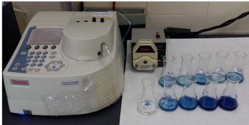
Slika 92: Očitavanje fosfora na spektrofotometru
