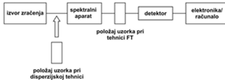
Slika 17: Shema IR spektrometra
