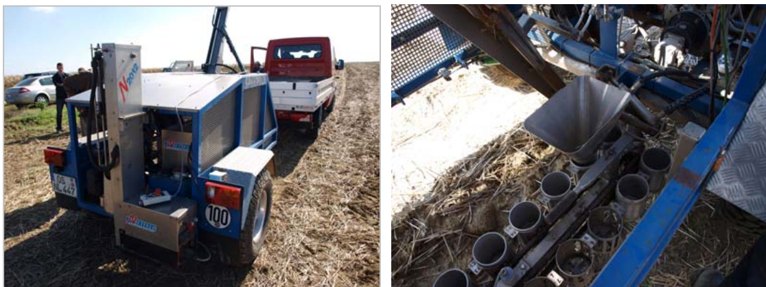
Slika 37: Strojni uređaj N2012 za uzorkovanje tla
