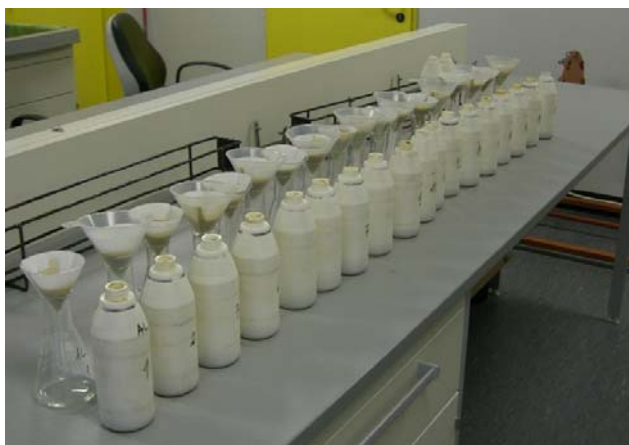
Slika 89: Filtriranje nakon ekstrakcije AL-otopinom
