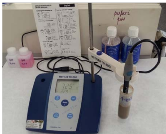
Slika 61: Očitavanje pH na pH metru
