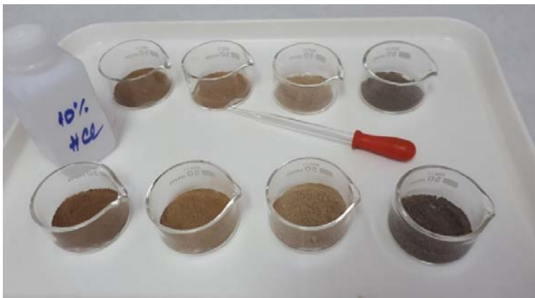
Slika 1: Pribor za kvalitativno određivanje karbonata u tlu
