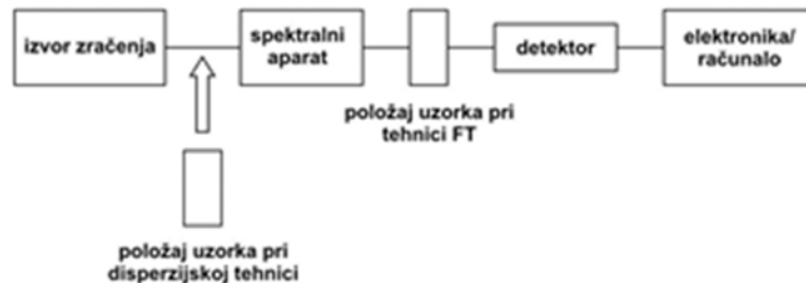
Slika 17: Shema IR spektrometra
