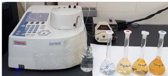
Slika 80: Očitavanje na spektrofotometru (436 nm)
