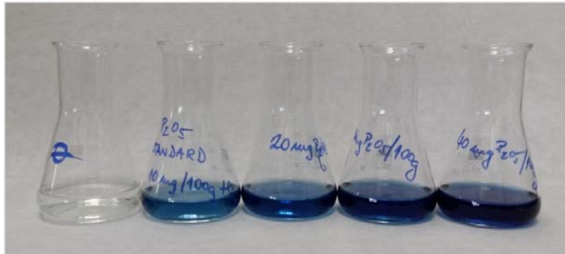
Slika 91: Serija standardnih otopina za baždarenje spektrofotometra
