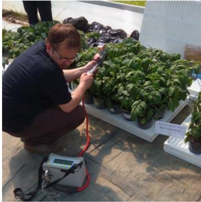
Slika 6. Mjerenje fotosinteze (Izvor: Borjan Ranilović)
