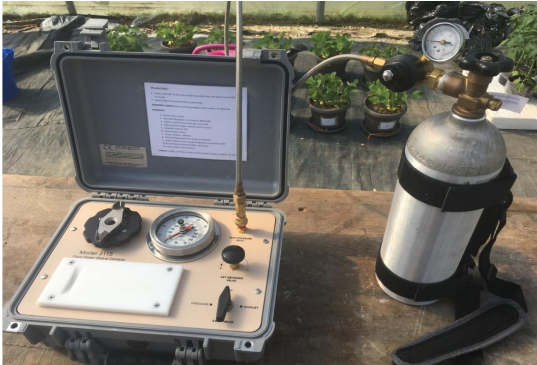
Slika 5. Instrument za mjerenje vodnog potencijala lista
