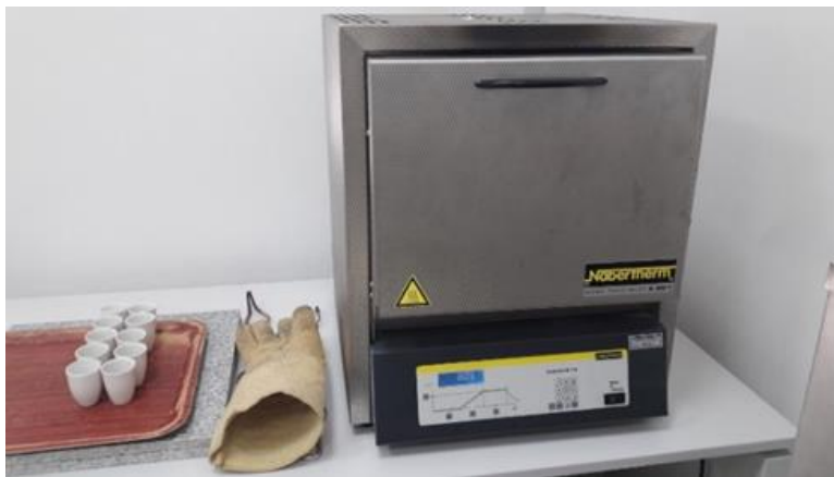
Slika 3.2.3.1. Mufolna peć (Nabertherm Controller B170, Njemačka)
