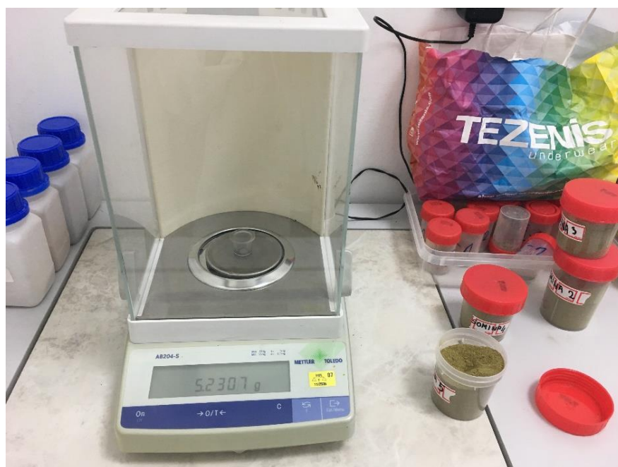
Slika 3.2.8.2. Vaganje uzorka za kalorimetriju na analitičkoj vagi
