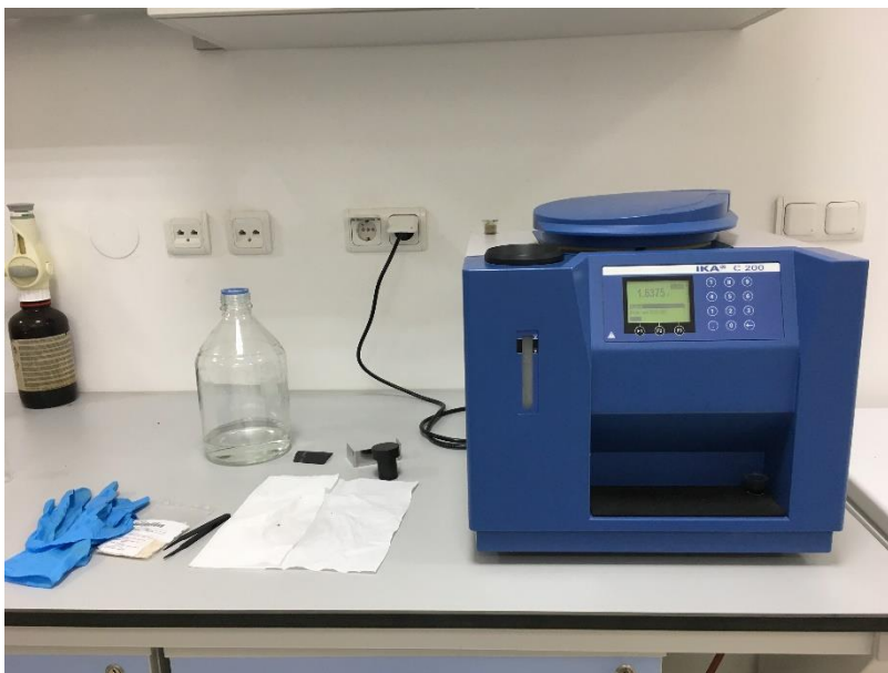
Slika 3.2.8.1. Adijabatski kalorimetar (IKA C200 Analysentechnik GmbH, Njemačka)
