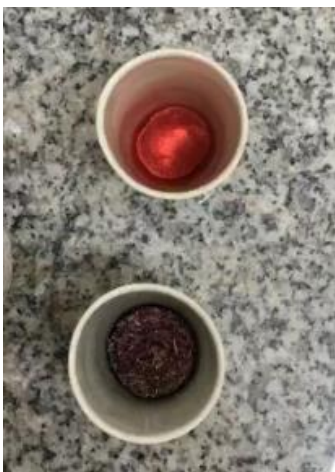
Slika 3.2.4.1. Koks nakon spaljivanja u mufolnoj peći
