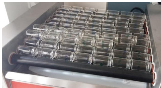
Slika 3.3.1. Ravnomjerno raspoređivanje pojedinih djelatnih tvari po stjenkama staklenih bočica na roleru
