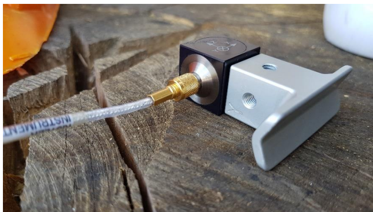
Slika 7. – Troosni akcelometar TIP 8762A10
