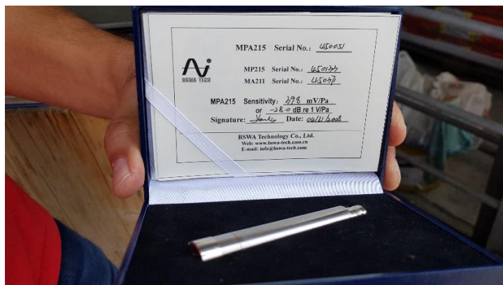
Slika 16. – Zvukomjer BSWA TECH – MPA 215
