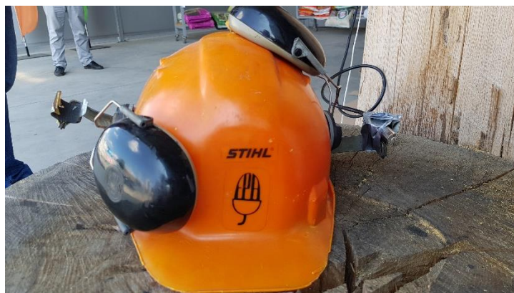
Slika 15. – Zaštitna kaciga na koju je montiran uređaj za mjerenje razine buke
