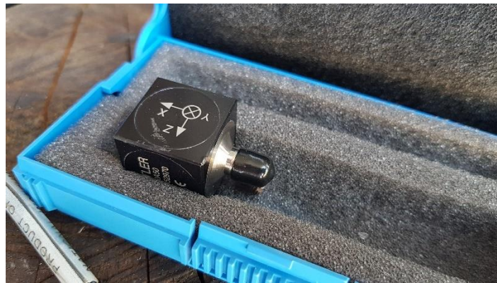
Slika 9. - Troosni akcelerometar tip 8762A10
