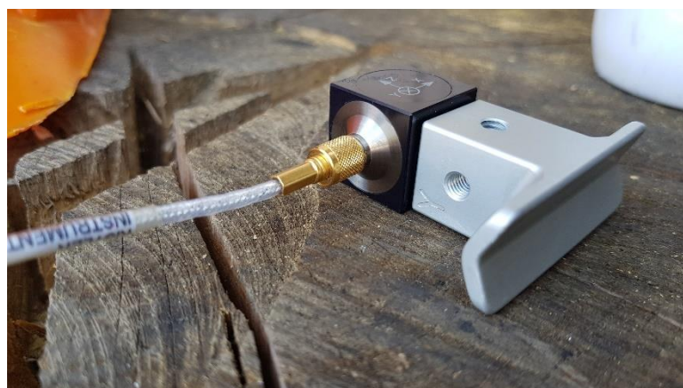
Slika 7. – Troosni akcelometar TIP 8762A10
