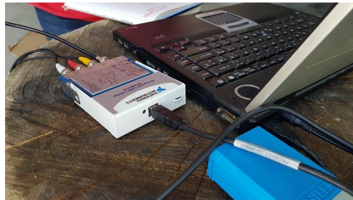
Slika 10. - National Instruments tip NI USB 9162
