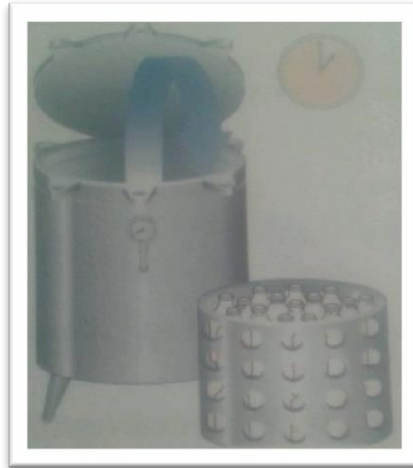
Slika 18. Stacionarni autoklav (Izvor: Bylund, 1995.)
