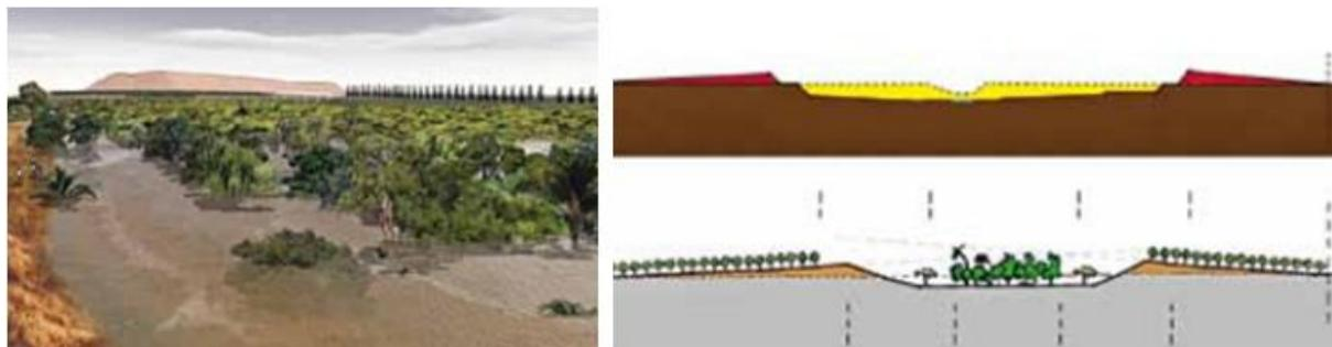
**Slika 31:** Retencijski bazen s prikazom iskopa: a) prostorni prikaz, b) presjek
