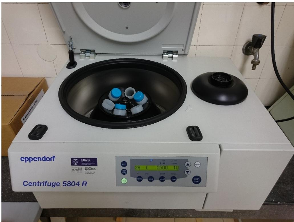
Slika 8. Centrifuga s unutarnjim hlađenjem (Izvor: Žagar, F. original)
