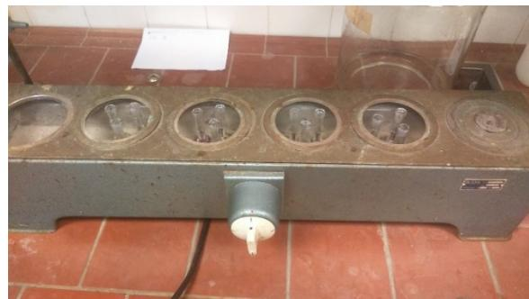
Slika 7. Zagrijavanje uzorka u vodenoj kupelji (Izvor: Žagar, F. original)
