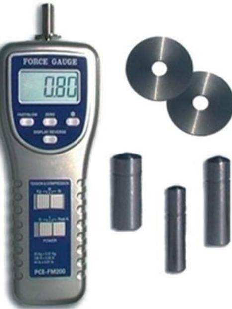
Slika 3. Digitalni penetrometar
