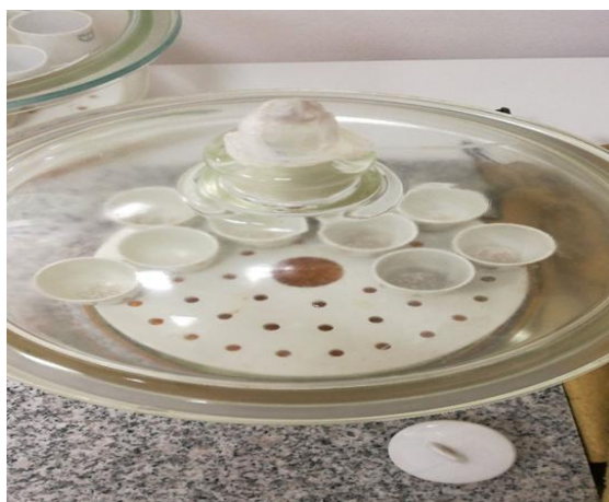
Slika 3.2.3.1. Eksikator sa lončićima nakon spaljivanja (Izvor: vlastiti izvor)
