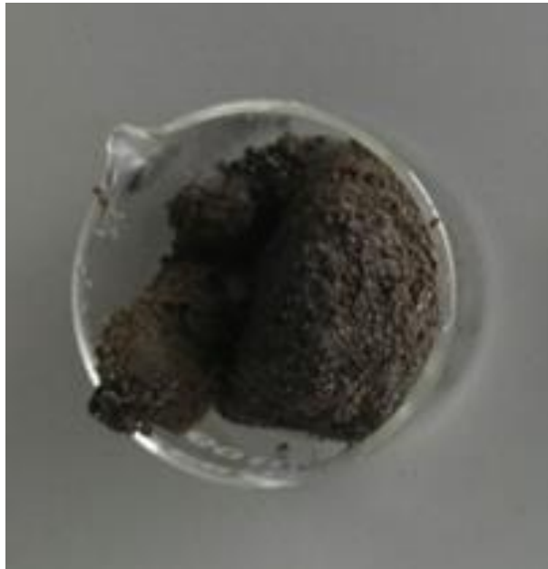
Slika 4. Izgled pepela nakon nastanka u postrojenju
