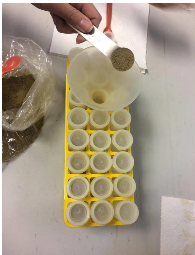
Slika 12. Postupak punjenja kiveta tlom
