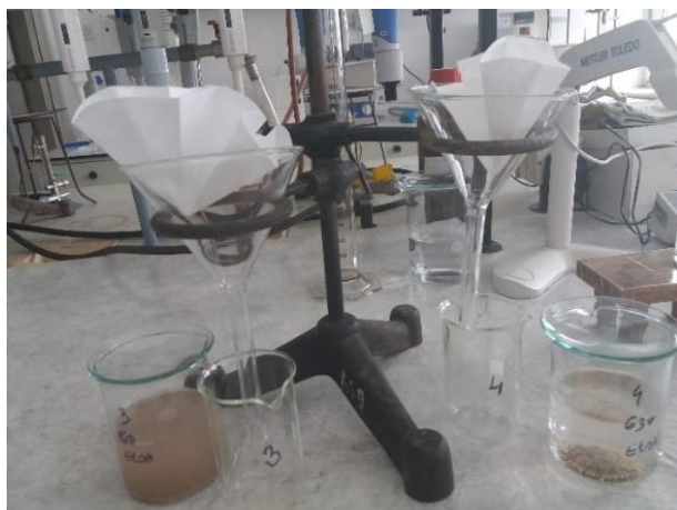
Slika 14. Filtriranje uzoraka praha sikavice nakon klasične ekstrakcije
