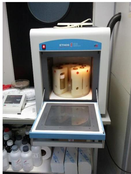
Slika 19. Uzorci u mikrovalnoj peći
