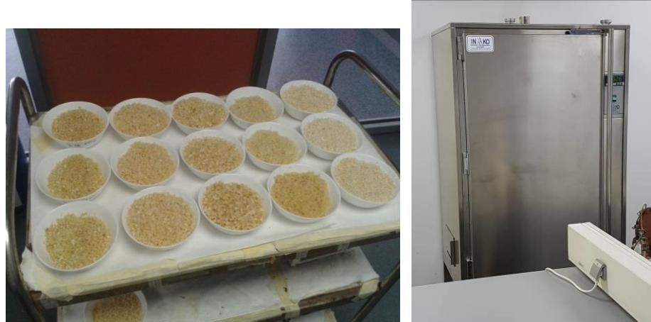
Slika 15. Uzorci pripremljeni za sušenje na 105°C Slika 16. Termostat
