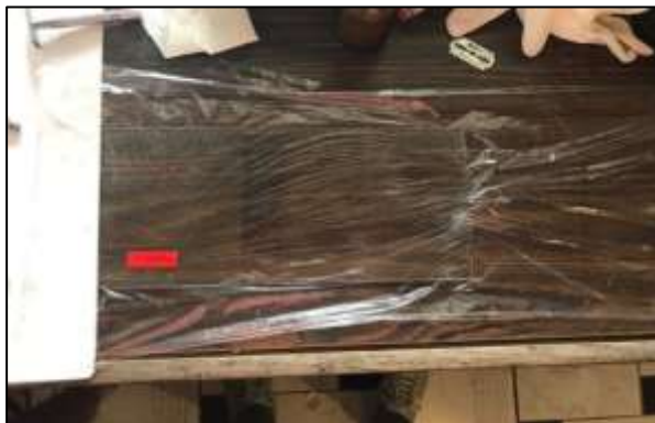
Slika 12. Zamatanje stakla folijom
