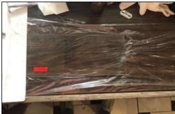
Slika 12. Zamatanje stakla folijom
