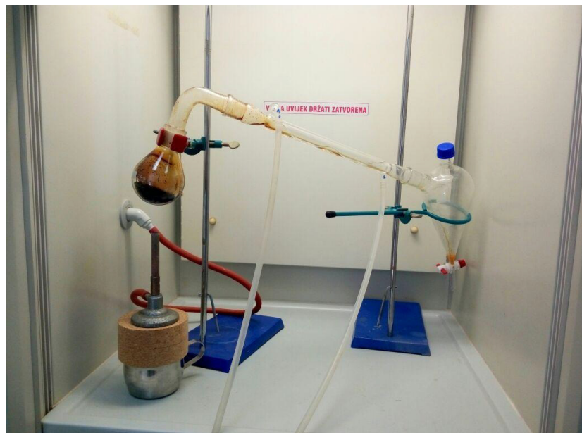
Slika 11. Sustav za provođenje laboratorijskog procesa pirolize
