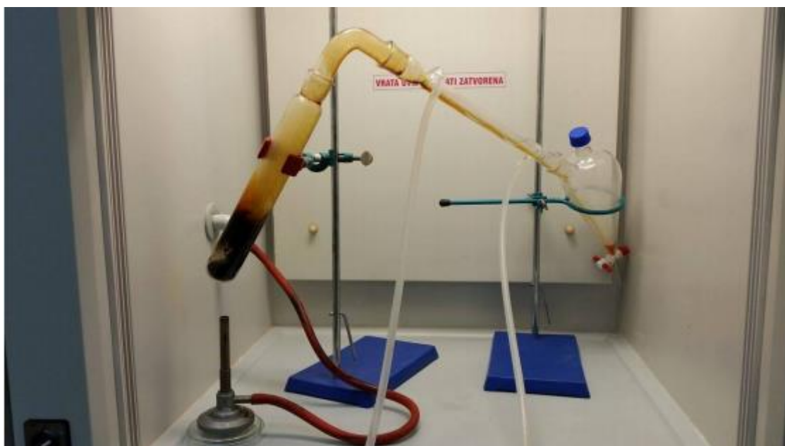
Slika 4.5. Prikaz aparature i procesa pirolize
