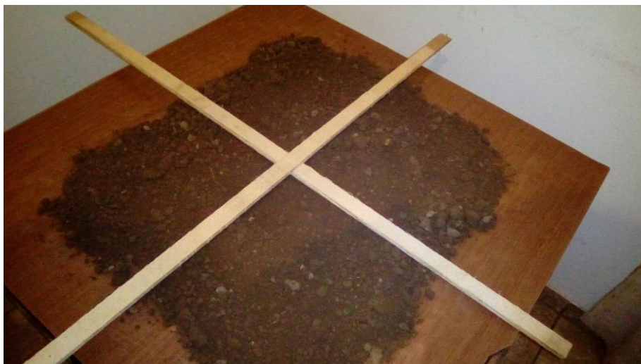
Slika 3.1.2. Priprema uzorka tla za kemijsku analizu postupkom četvrtanja
