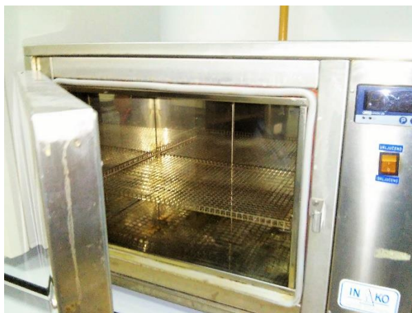
Slika 6. Laboratorijska sušnica (snimila: T. Mavričić)
