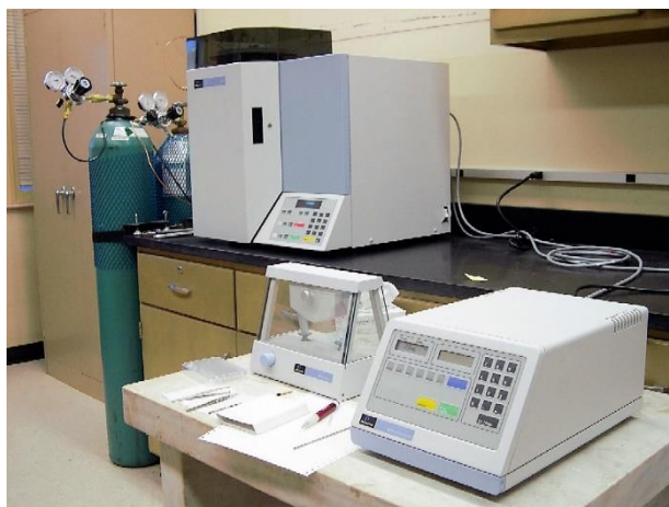
Slika 9. CHNS analizator (Izvor: www.depts.ttu.edu )
