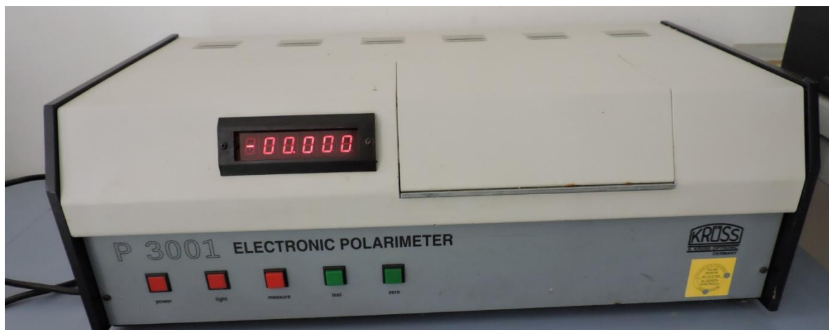
Slika 13. Polarimetar KRÜSS, P3001 Snimila: Ana Čale
