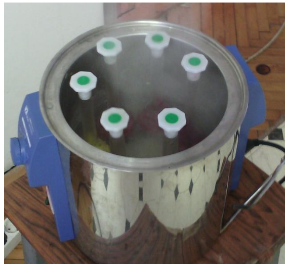
Slika 15. Prikaz kuhanja uzoraka u parnoj kupelji u svrhu određivanja škroba
