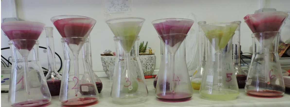
Slika 14. Prikaz filtriranja uzoraka za postupak određivanja škroba u polarimetru
