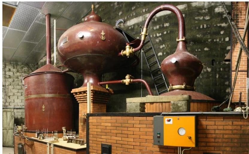
Slika 2.4. Alambic destilacijski uređaj
