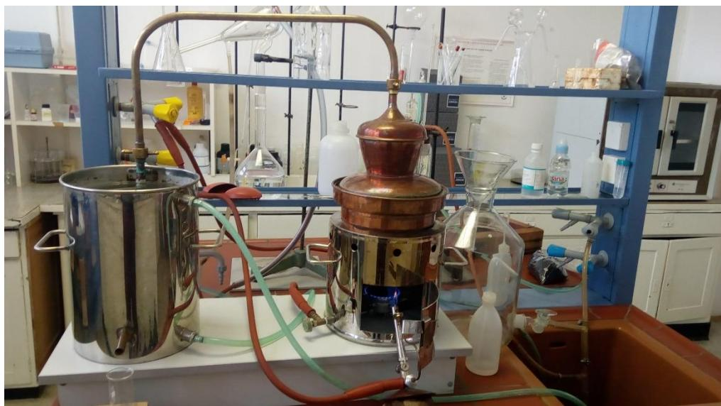
Slika 3.6. Jednostavni destilacijski uređaj *alambic* kapaciteta 5 L
