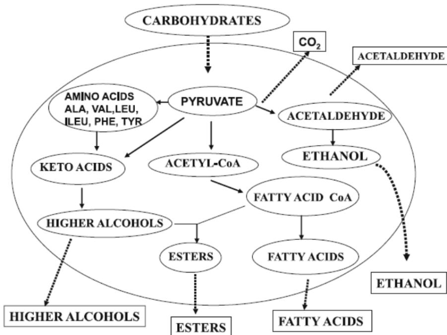
Slika 2.8. Shematski prikaz nastanka prekursora, metabolita i nusprodukata glavnih skupina spojeva odgovornih za senzorne karakteristike vina, a kasnije i destilata
