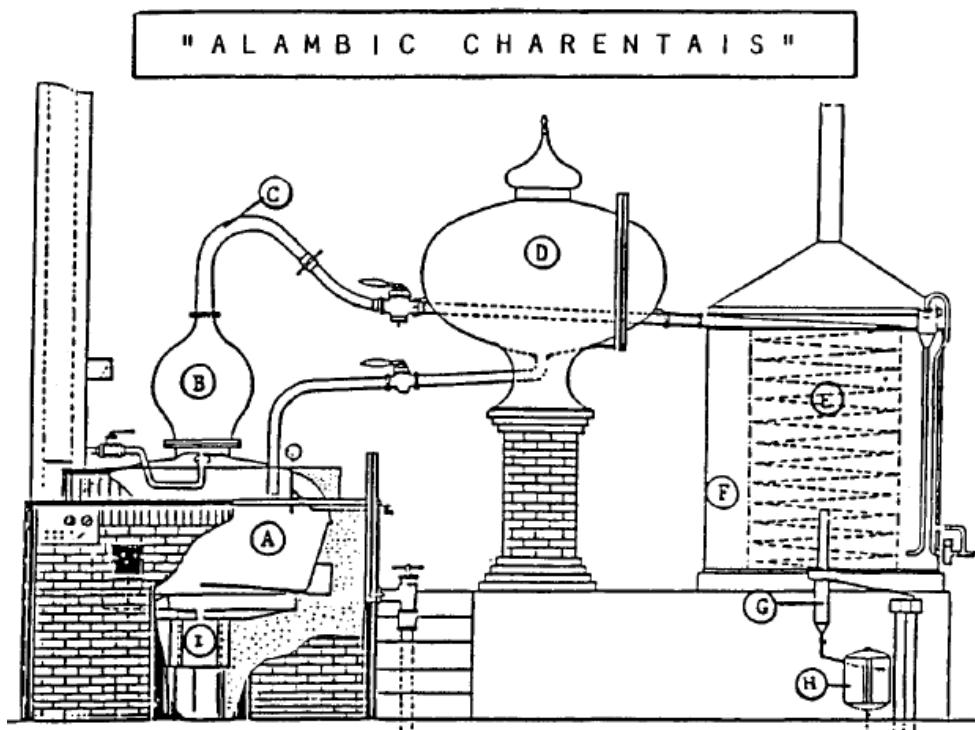
Slika 2.5. Shematski prikaz građe alambic destilacijskog uređaja
