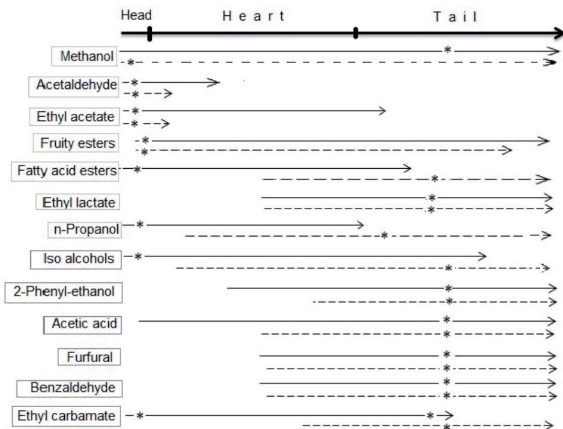
Slika 2.10. Podjela hlapivih spojeva prema početku i kontinuitetu hlapljenja (puna crta-alambic uređaj, \*akumulirane visokih koncentracija hlapivih spojeva)
