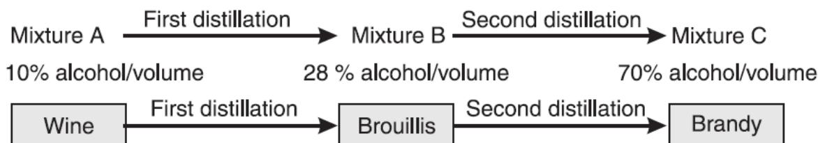
Slika 2.6. Shematski prikaz dvostrukе destilacije
