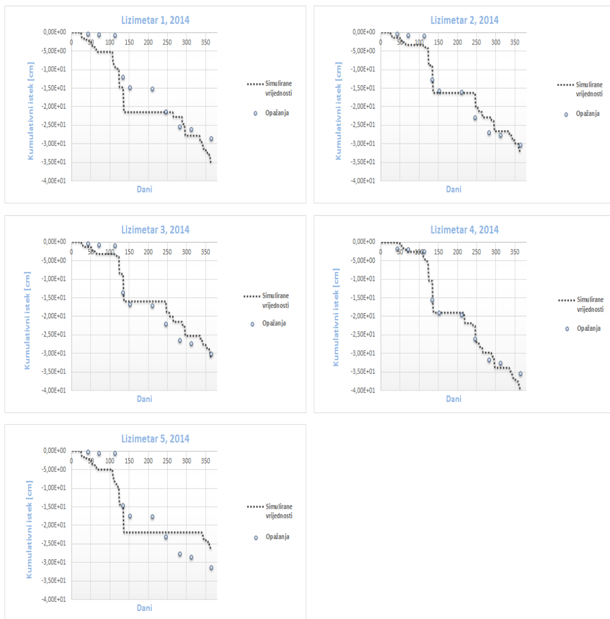
Slika 23. Izmjerene i simulirane (HYDRUS-1D) kumulativne vrijednosti procjedne vode (perkolata) iz lizimetara u 2014. godini
