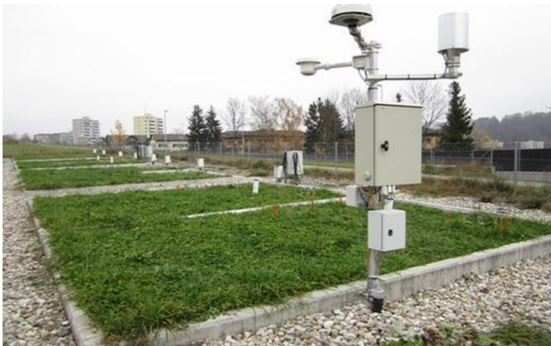
Slika 5. Pravokutni lizimetar (Izvor: http://www.soilprot.ethz.ch )
