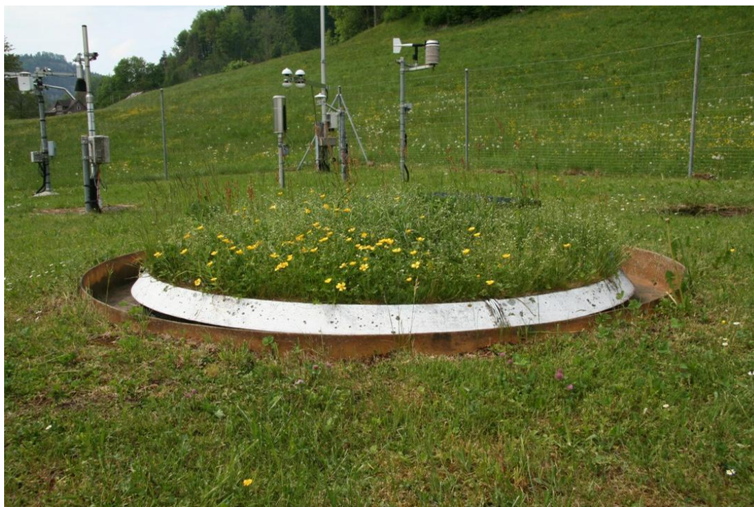
Slika 4. Kružni lizimetar (Izvor: http://www.iac.ethz.ch )
