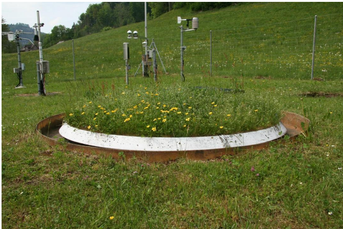
Slika 4. Kružni lizimetar (Izvor: http://www.iac.ethz.ch )
