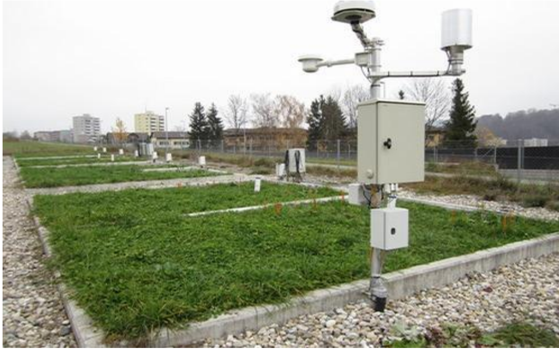
Slika 5. Pravokutni lizimetar (Izvor: http://www.soilprot.ethz.ch )
