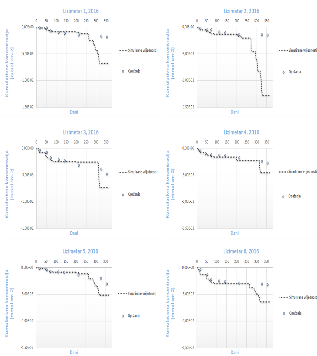
Slika 28. Izmjerene i simulirane (HYDRUS-1D) kumulativne vrijednosti koncentracije nitrata u procjednoj vodi (perkolatu) iz lizimetara u 2016. godini
