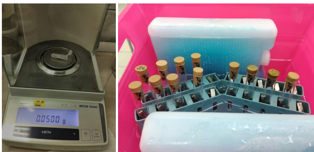
Slika 8. Vaganje guar gume. 9. Kušalice s alikvotima na stalku uronjenom u ohlađenu vodu Izvor: Novaković, K. – vlastiti izvor
