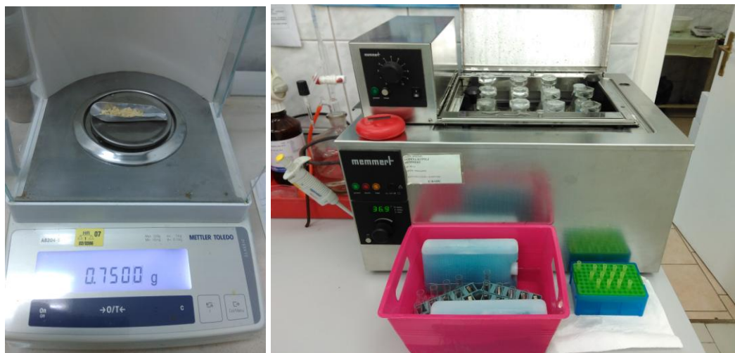
Slika 6. Vaganje uzorka za analizu. 7. Inkubacija uzoraka u vodenoj kupelji pri 37°C prilikom određivanja probavljivosti
