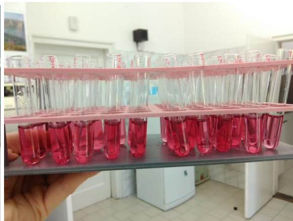
Slika 12. Kušalice za detekciju glukoze prije inkubacije. Slika 13. Kušalice za detekciju glukoze nakon inkubacije (sadrže GODOD reagens) Izvor: Novaković, K. – vlastiti izvor
