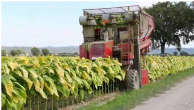
Slika 2.6. Strojna berba duhana (RA 632 model)
