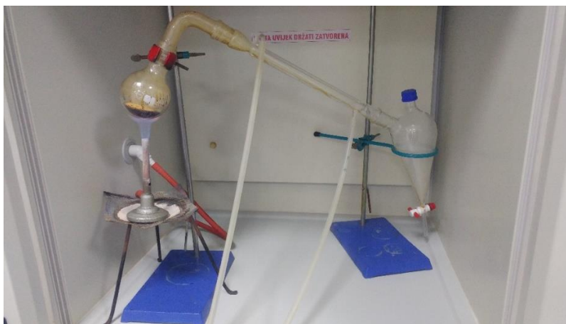
Slika 3 : Termokemijski proces pirolize (Izvor: vlastita arhiva)
