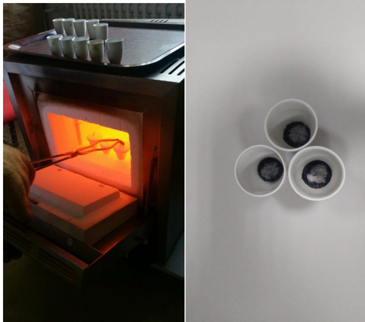
Slika 11 : Mufolna peć i sadržaj koksa (Izvor : vlastita arhiva)
