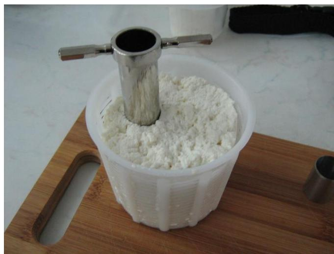
**Slika 3.5.1.** Uzimanje uzorka za test kompresije
