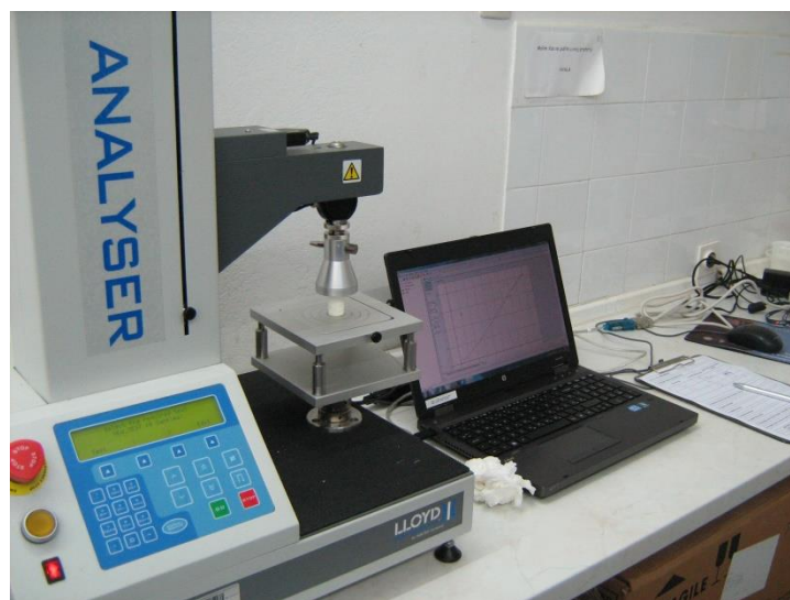
Slika 3.5.3. Test kompresije i grafički prikaz rezultata
