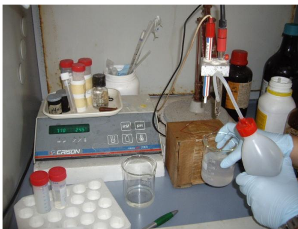
Slika 23. Beckhamov pH metar (foto: V.Šoštarčić)
