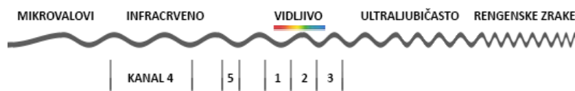
Slika 6.15. Prikaz kanala u multispektralnom snimanju (prilagodio autor)
