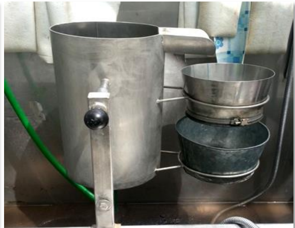
Slika 10. Spearsov flotacioni uređaj za ispiranje uzoraka (Dubičanac, 2014)
