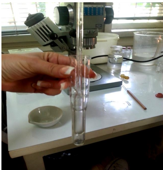
Slika 15. Drobljenje cista u Huijsmansovom homogenizatoru (Dubičanac, 2014)
