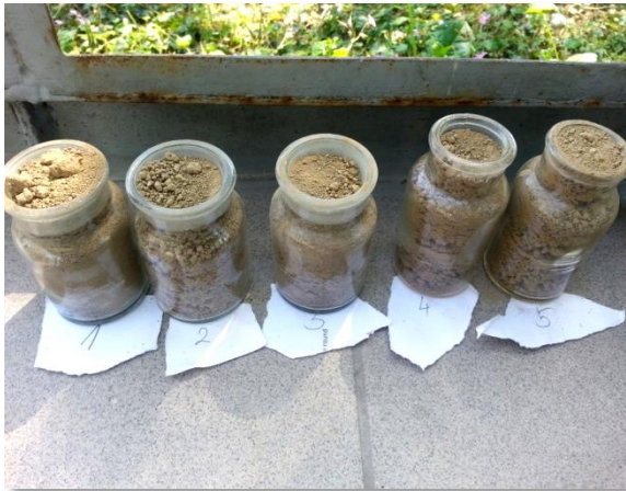
Slika 9. Uzorci tla pripremljeni za ispiranje (100 ml) (Dubičanac, 2014)
