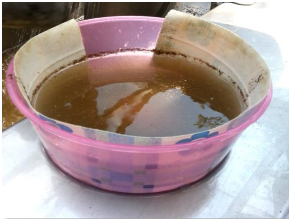
Slika 11. Izdvajanje cista iz ispranog uzorka pomoću posude obložene PVC trakom (Dubičanac, 2014)
