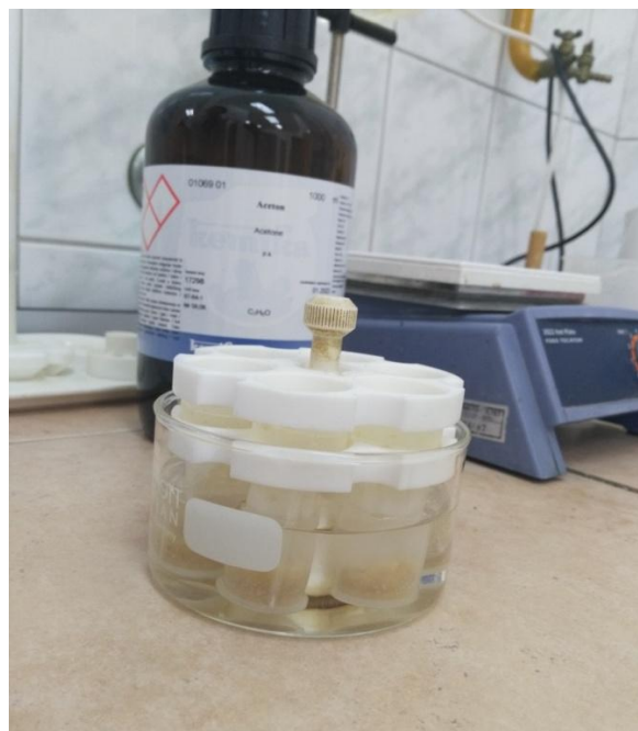
Slika 3.3.1.3. Odmaščivanje uzorka u acetonu nakon kuhanja u neutralnom detergentu Izvor: Vlastiti izvor
