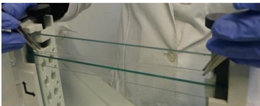
Slika 14. Umetanje IPG trake na gel koji je polimerizirao.
