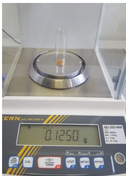
Slika 6.2.2. Vaganje osušenih sjemenki mase 125 mg
