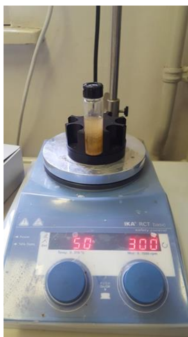
Slika 6.2.3. Ekstrakcijska smjesa ostavljena na magnetskoj mješalici pri temperaturi 50 °C
