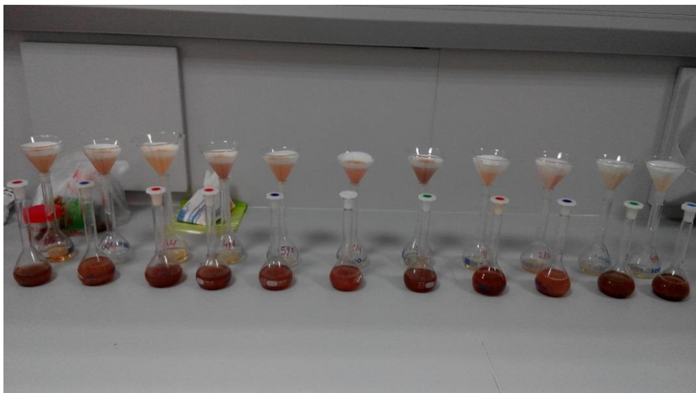
Slika 6.6.3. Uzorak pripremljen za očitavanje škroba
