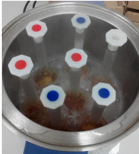
Slika 6.6.2. Uzorak za određivanje škroba u vodenoj kupelji
