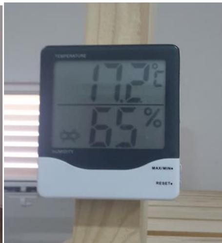
**Slika 3.6.** Vlagomjer za mjerenje
