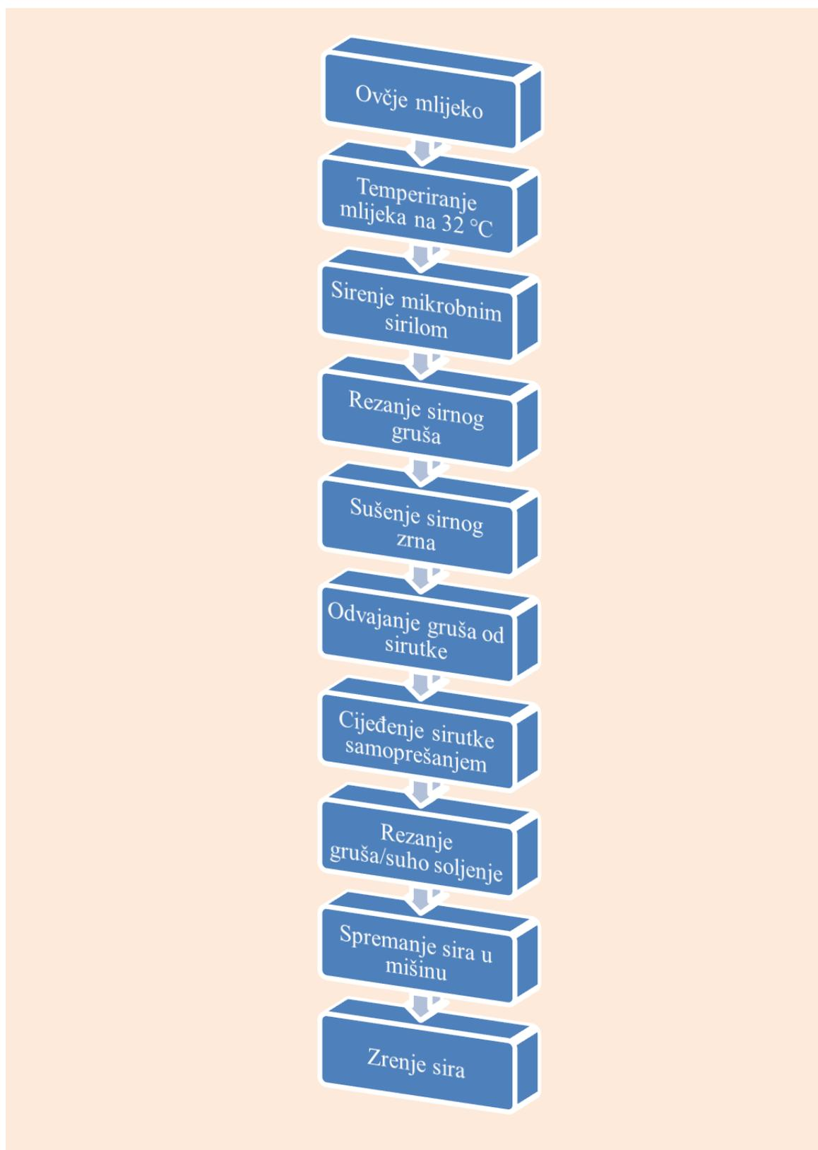
**Slika 3.7.** Dijagram toka proizvodnje sira iz mišine
