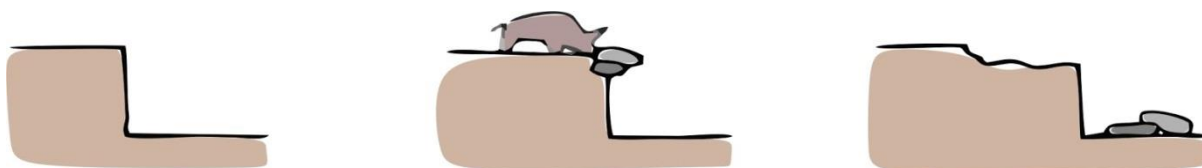
Slika 2.19. Utjecaj divljih životinja na stabilnost zida; Izvor: http://www.alpiter.net/IMG/pdf/UNIMI_bonardi_11_05.pdf
