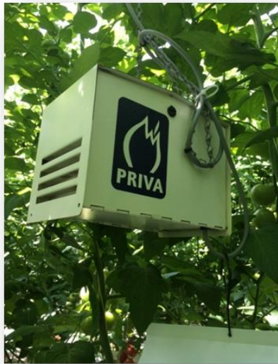
Slika 5. Instrument za mjerenje temperature (termometar) i relativne vlažnosti zraka (higrometar) (Ivanković, 2015.)
