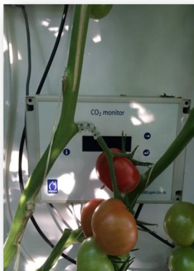
Slika 6. Uređaj za kontrolu CO 2 u zaštićenom prostoru (Ivanković, 2015.)
