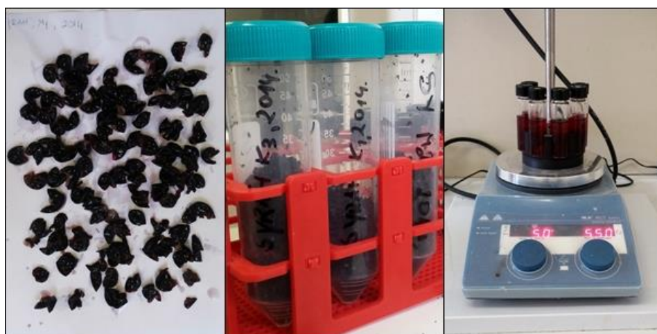
Slika 10: Prikaz pripreme uzoraka kožice i magnetska miješalica
