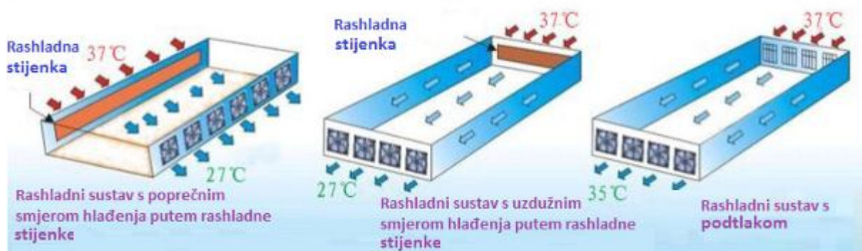
Slika 6. Prikaz načela rada rashladnog sustava s podtlakom
