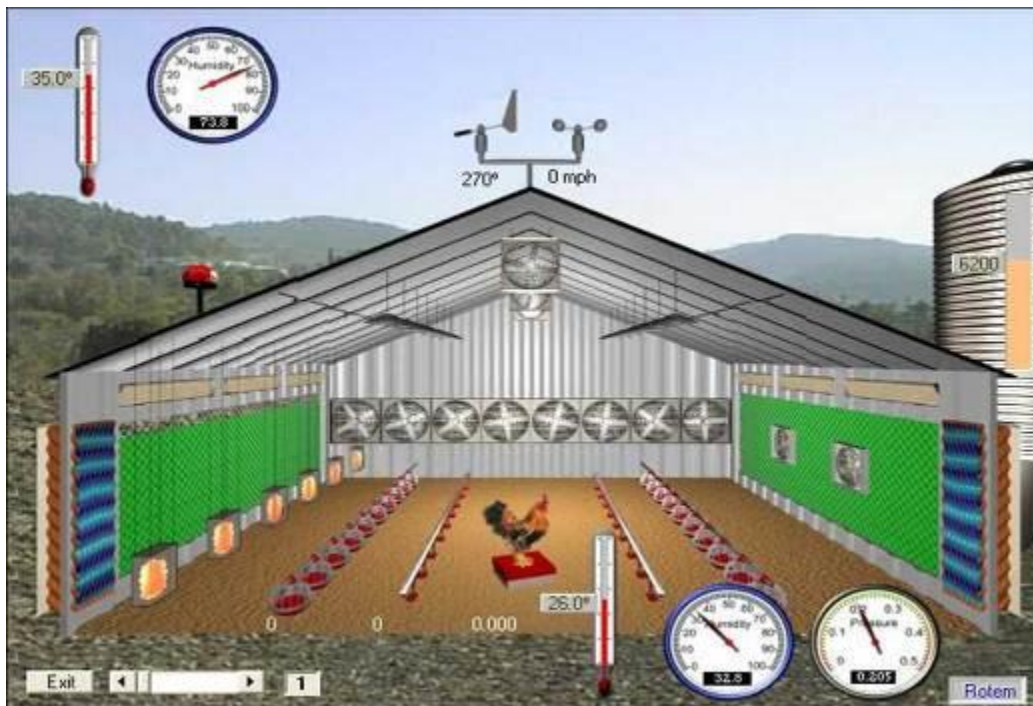
Slika 14. Karakteristični elementi i parametri sustava upravljanja i vođenja podnog načina držanja peradi
