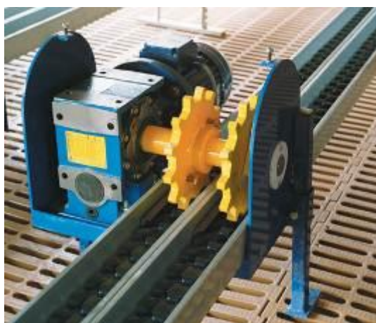
Slika 37. Reduktor za pogon beskrajnog lanca lančano distributivnog transportera ( www.alibaba.com )
